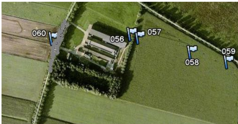
Figuur 1. Voorbeeld van de plaatsing van de meetpalen op respectievelijk 50 m bovenwinds (060), 30m (057), 160m (058) en 250m (059) benedenwinds van het veehouderijbedrijf.
